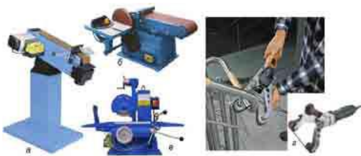
Мал.32. Шліфувальні верстати: а – стрічково-шліфувальний; б – шліфувально-полірувальний комбінований; в – площинно-шліфувальний; г – шліфування труб
