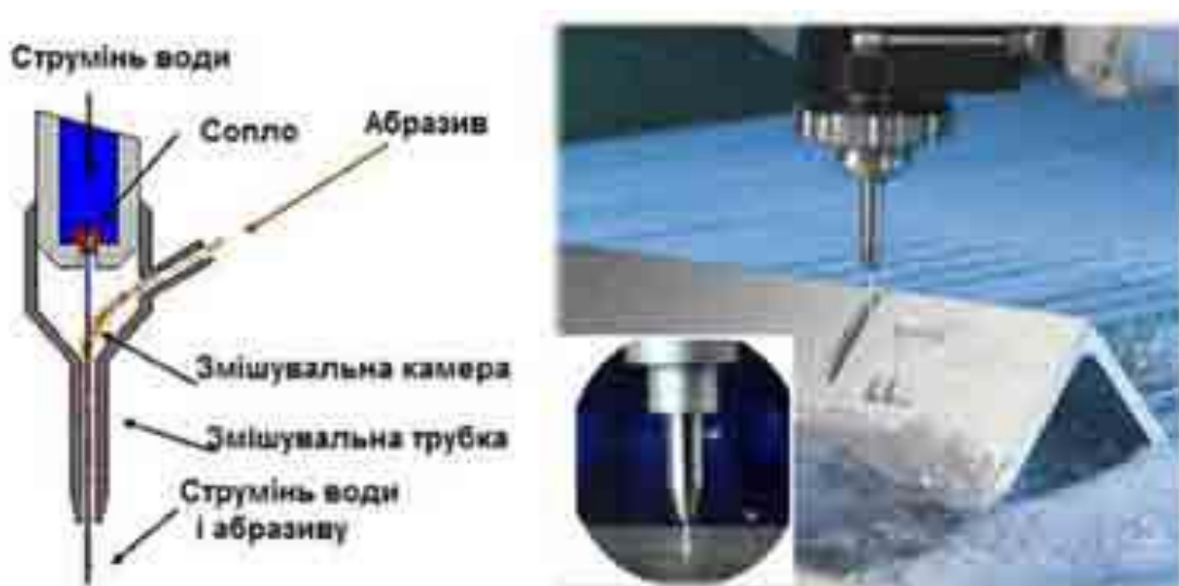
Мал.38. Гідроабразивна обробка: а – схема; б – процес обробки
