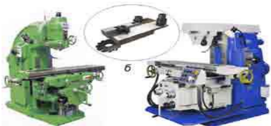
Мал.30 . Фрезерування металу: а, в – фрезерні верстати; б – обробка поверхонь фрезами Для обробки плоских поверхонь деталей машин використовують стругальні верстати .
