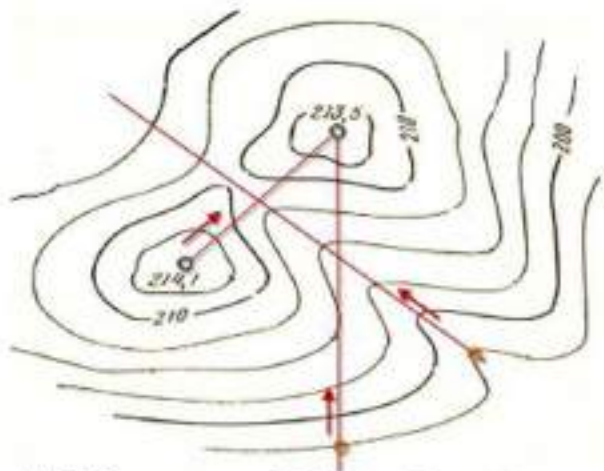
Рис. 4.35. Зображення двох горбів і долини між ними (модель земної поверхні) у масштабі 1 сантиметр 200 метрів, відстань по висоті між лініями рівня — 2,5 м
