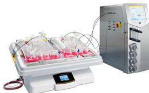
Мал. 14. Біореактор Biostat® RM з використанням коливального руху для вирощування клітин ссавців, комах, рослин (джерело http://surl.li/rqgnz )
